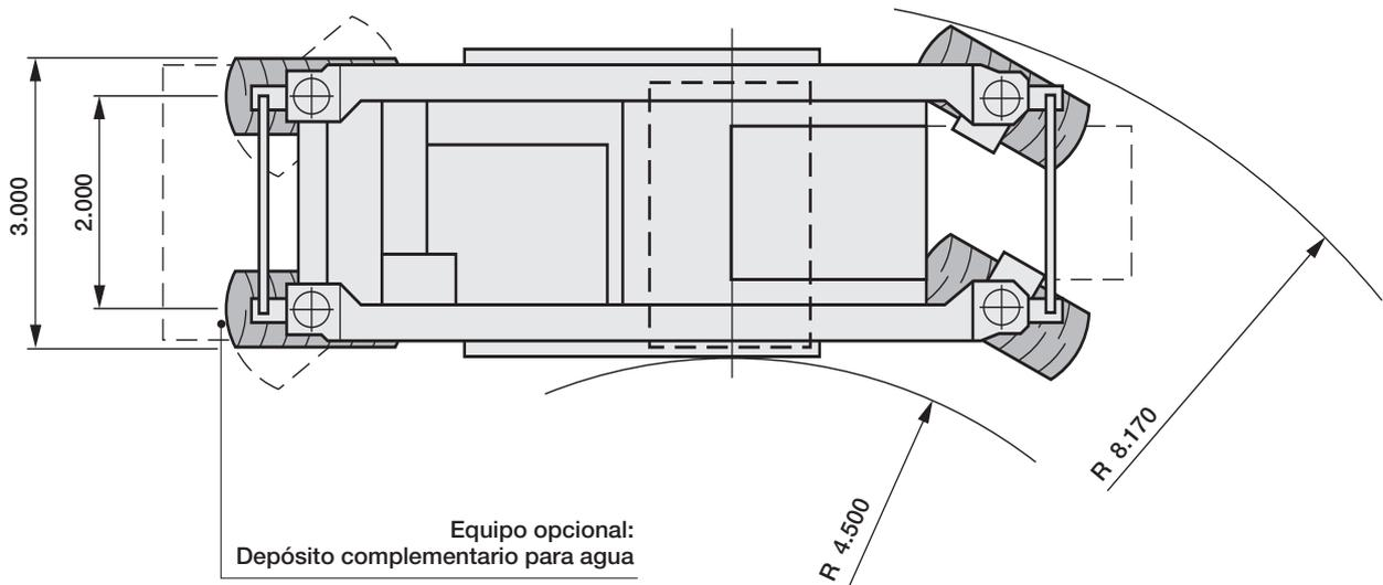
Anchura de la máquina con equipo opcional «Anchura de fresado 3.048 mm»: 3.700 mm
